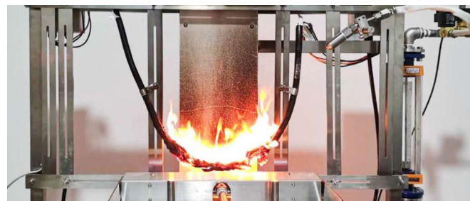
تجهیز پیوستگی جریان برای قطرهای بالای ۲۰ میلیمتر ▲
