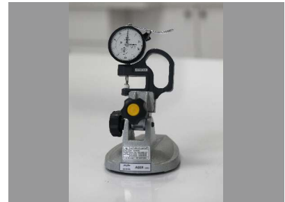
تجهیز ضخامت سنج جهت اندازه گیری ضخامت
