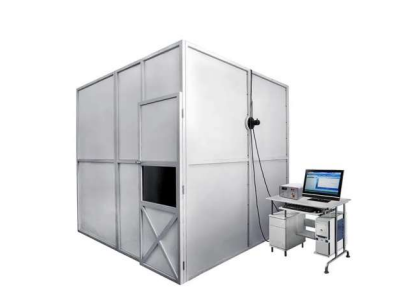
▲ تجهیز اتاق دود جهت اندازه گیری چگالی دود ناشی از سوختن کابل
