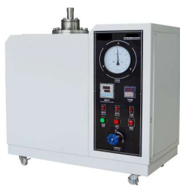
▲ تجهیز بمب هوا جهت آزمون کهنگی در محفظه اکسیژن
