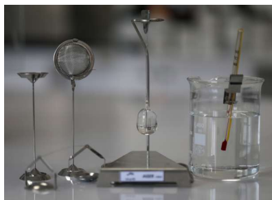
تجهیز چگالی جهت اندازه گیری چگالی مواد
