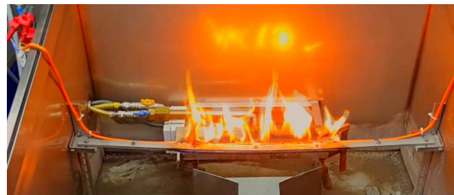
تجهیز CATw جهت آزمون پیوستگی تحت شعله مستقیم و پاشش آب ▲
