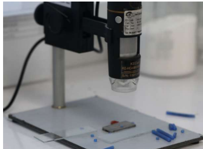
تجهیز میکروسکوپ جهت آزمون ابعادی
