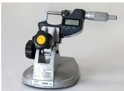
▲ تجهیز میکرومتر جهت اندازه گیری قطر هادی
