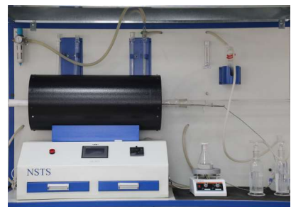
تجهیز هالوژن فری جهت اندازه گیری گاز های هالوژن
