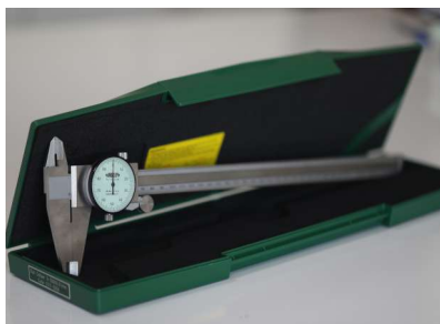
تجهیز کولیس جهت اندازه گیری ابعادی
